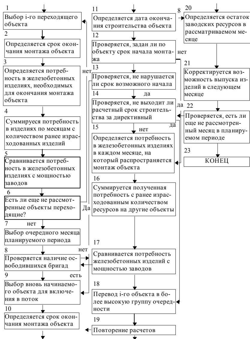
Рис. 18. Укрупненная блок-схема алгоритма разработки годового графика монтажа объектов непрерывным потоком
