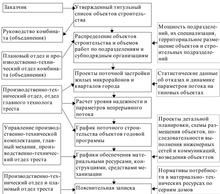
Рис. 17. Порядок разработки документации по организации работы комбината (объединения) непрерывным потоком
