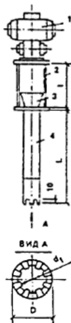
Рисунок прил. 5. Уплотнительное устройство
