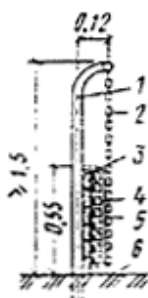
Рис. 6. Ограждение места для толкания ядра (размеры 1 метрах)
