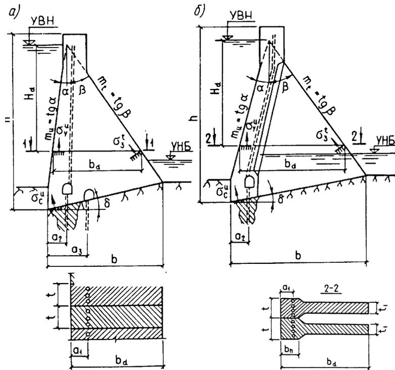
Черт. 10. Обозначения к расчету плотины на прочность
