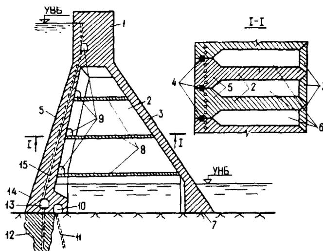
Черт. 11. Отдельные части и элементы массивно-контрфорсной плотины
