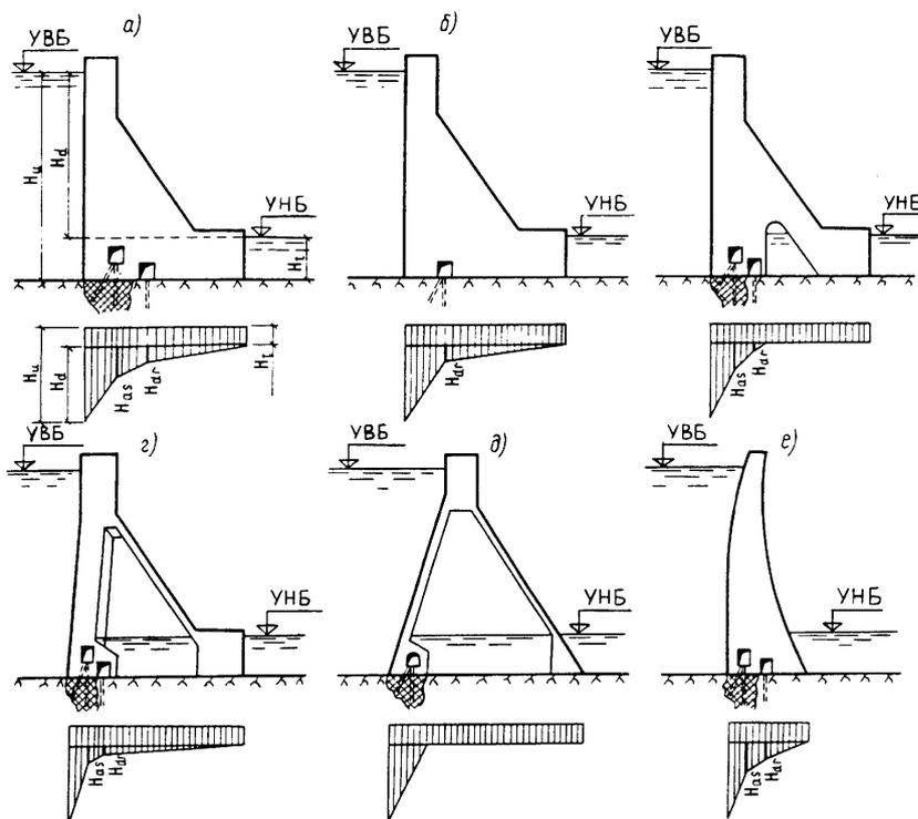
Черт. 7. Эпюры пьезометрического напора по подошве плотины
