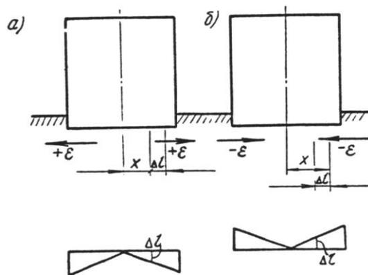
Черт. 2. Схемы к расчету перемещению точек земной поверхности под воздействием горизонтальных деформаций
