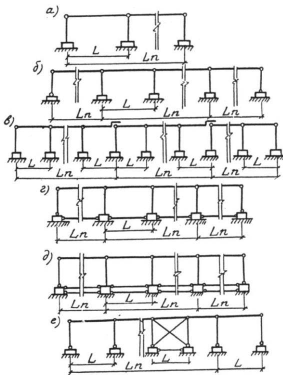
Черт. 3. Схемы поперечных рам одноэтажных каркасных зданий
