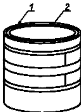
1 — защитное покрытие; 2 — металлическая подложка (труба)
