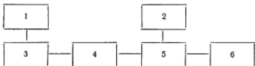
1 — частотомер; 2 — измеритель напряжений или измерительный усилитель; 3 — генератор; 4 — развязывающее устройство; 5 — поверяемый измеритель; 6 — образцовая мера полного сопротивления
