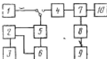
1 — источник переменного тока; 2, 8 — потенциометры постоянного тока; 3, 9 — образцовые меры т. э. д. с. (нормальный элемент); 4 — переключатель направления постоянного тока; 5 — эталонный или образцовый преобразователь; 6 — поверяемый прибор; 7 — образцовая мера сопротивления; 10 — источник постоянного тока
