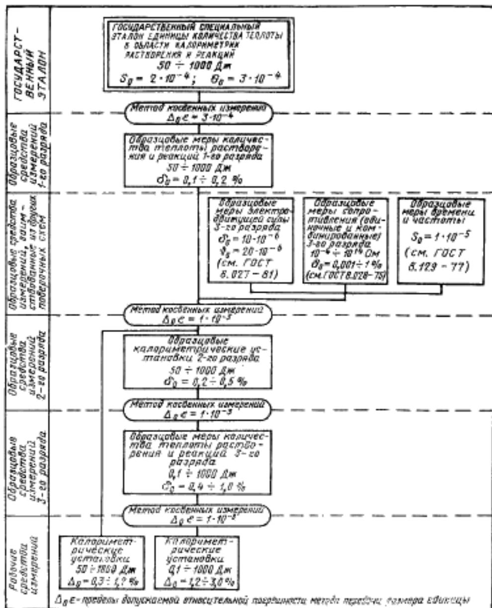
2.2.2. Образцовые средства измерений, заимствованные из других поверочных схем, применяют для поверки образцовых 2-го разряда и рабочих средств измерений методом косвенных измерений.
