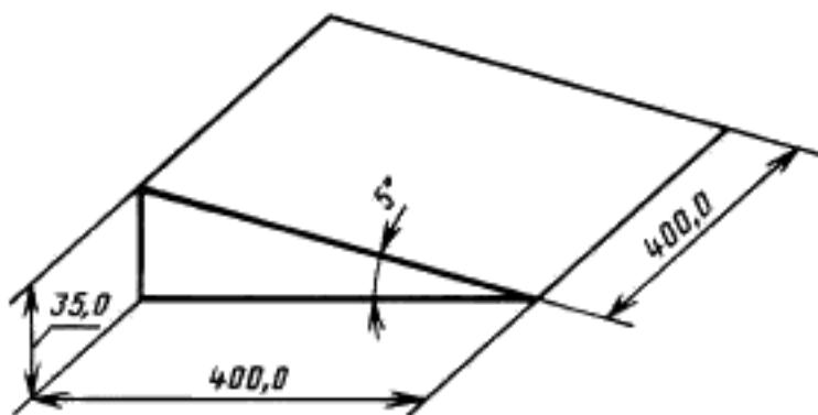
Приспособление представляет собой наклонную плоскость с углом наклона  $5^\circ$ , которое устанавливают на горизонтальной поверхности поверочного стенда или стола. Приспособление может быть изготовлено из любого металла (из алюминия или алюминиевых сплавов). Его собирают из отдельных элементов (пластины и боковых укосин) или отливают в виде полой детали. Наклонную поверхность обрабатывают соответствующим образом для придания ей плоскостности.
