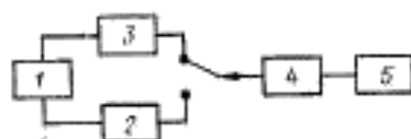
1—низкочастотный генератор; 2—поверяемый генератор; 3—генератор, работающий в режиме «ВНЕШНЯЯ АМ»; 4—измеритель модуляции; 5—анализатор спектра.
