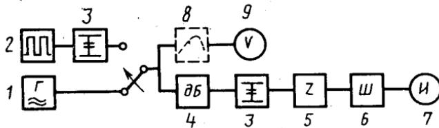
1—генератор синусоидального напряжения; 2—генератор импульсов; 3—согласующее звено; 4—магазин затуханий; 5—эквивалент микрофона; 6—электрическая часть шумомера; 7—измерительный прибор шумомера; 8—фильтр А, В, С, Д по ГОСТ 17187—81; 9—вольтметр эффективных значений.
