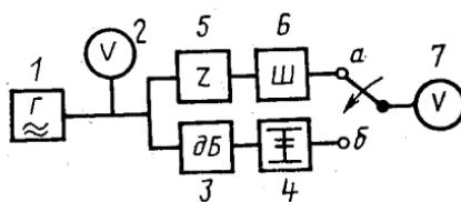
1—генератор; 2—вольтметр; 3—магазин затуханий; 4—согласующее звено; 5—эквивалент микрофона; 6—электрическая часть шумометра; 7—вольтметр или самописец.
