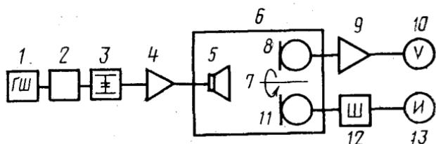
1—генератор; 2—третьюоктавный фильтр; 3—согласующее звено; 4—усилитель мощности; 5—громкоговоритель; 6—реверберационная камера; 7—координатное устройство; 8—образцовый микрофон; 9—микрофонный усилитель; 10—вольтметр; 11—микрофон шумомера; 12—электрическая часть шумомера; 13—измерительный прибор шумомера
