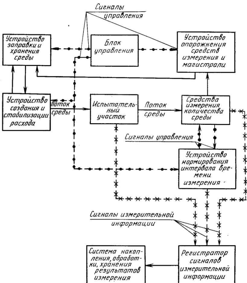
2. Проверочная расходомерная установка должна состоять из элементов, указанных в структурной схеме:
