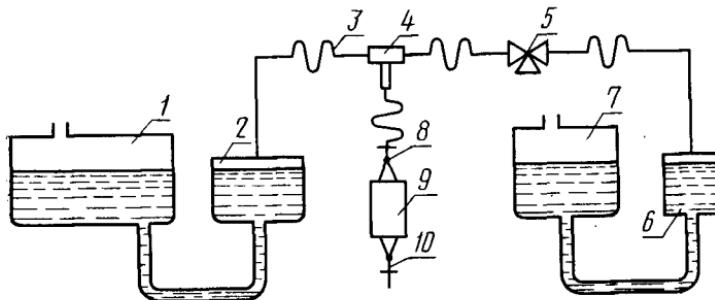
1, 2—подвижный и неподвижный сосуды рабочего эталона; 3—резиновые трубы; 4—тройник; 5—пробковый кран; 6, 7—неподвижный и подвижный сосуды проверяемого микроманометра; 9—сильфонный пресс с кранами 8, 10
