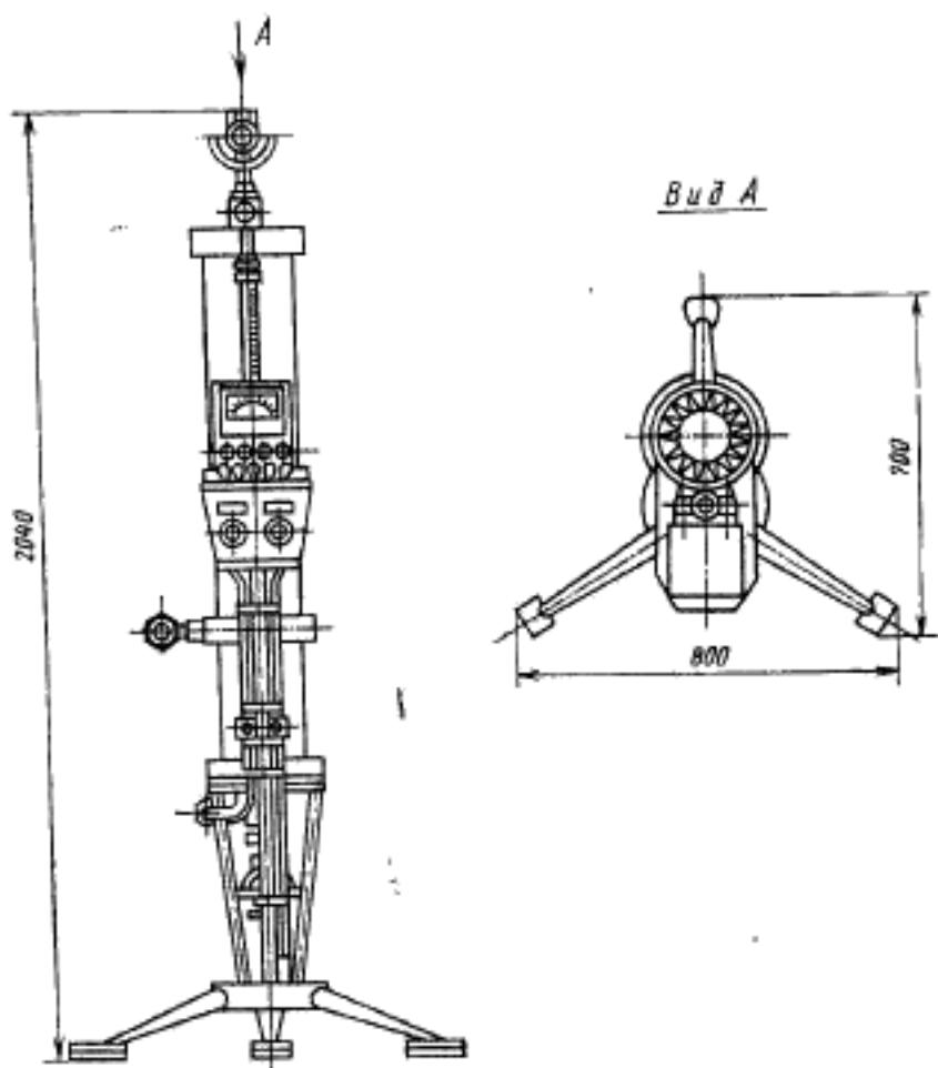
Пример условного обозначения установки финишной очистки воды:
