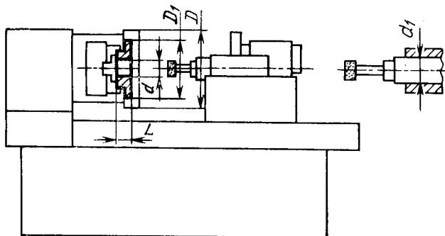
$d$ —наибольший диаметр шлифуемого отверстия;  $d_1$ —диаметр отверстия шлифовальной бабки под гильзу внутришлифовального шпинделя;  $D$ —наибольший диаметр устанавливаемой заготовки;  $D_1$ —наибольший диаметр устанавливаемой заготовки в кожухе;  $L$ —наибольшая длина устанавливаемой заготовки (без люнета)
