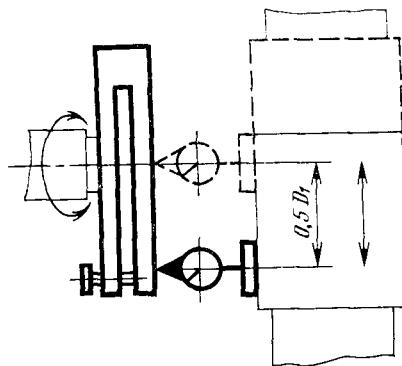
$$D_1 \geq \frac{D}{2} \text{, но не более } 500 \text{ мм,}$$
