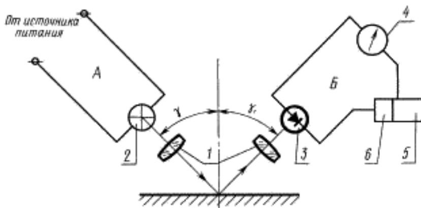
1.3. При измерении блеска оптические оси систем осветителя и фотоприемника должны находиться под равными углами ( $\gamma = \gamma_1$ ) относительно перпендикуляра к измеряемой поверхности. Точка пересечения осей должна лежать на поверхности измеряемого образца.
