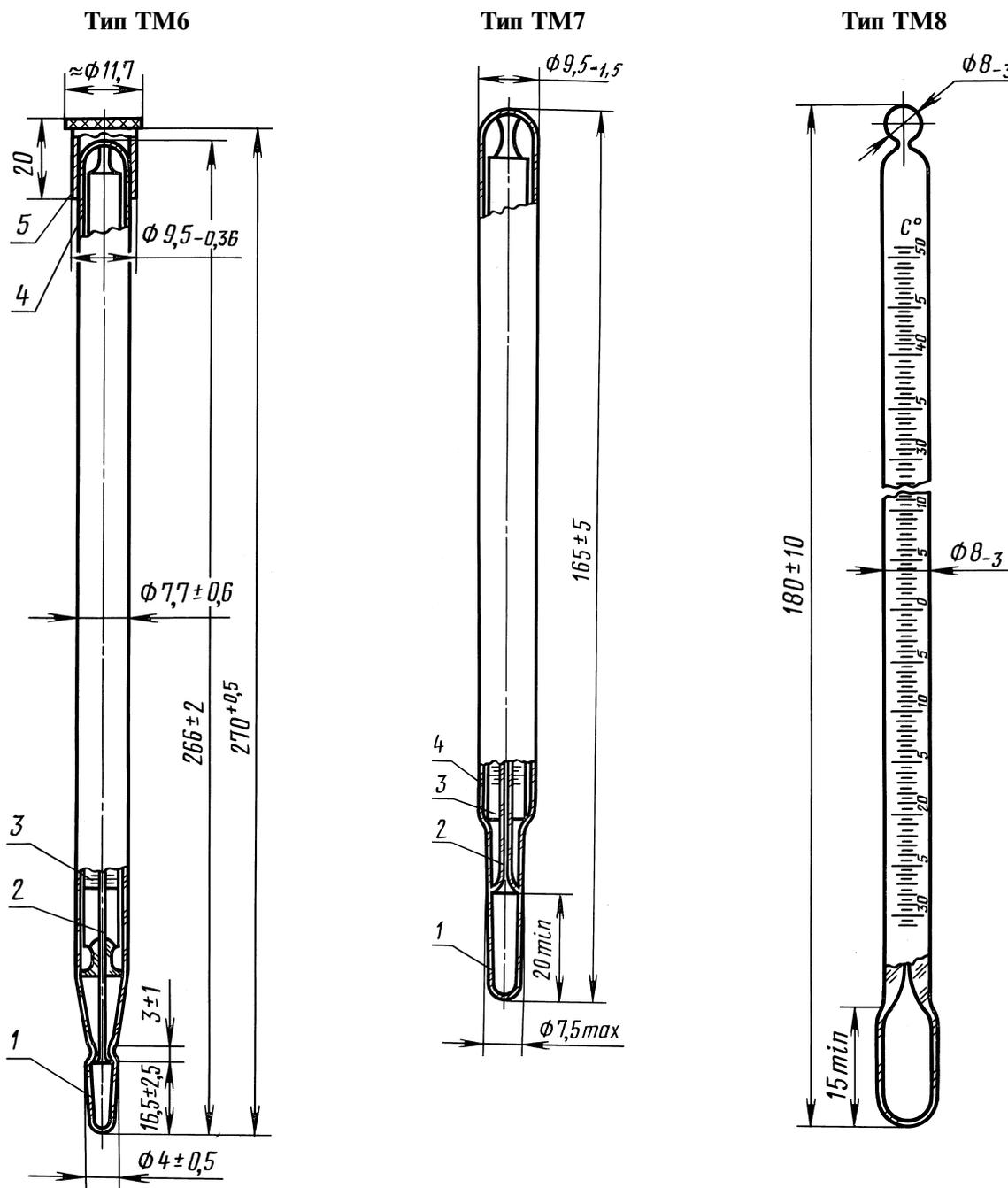
1 — резервуар; 2 — капиллярная трубка; 3 — шкальная пластина; 4 — оболочка; 5 — колпачок
