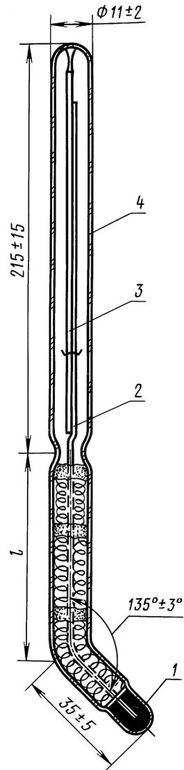
1 — резервуар; 2 — капиллярная трубка; 3 — шкальная пластина; 4 — оболочка
