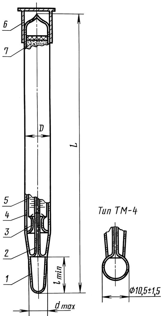
1 — резервуар; 2 — капиллярная трубка; 3 — седловина; 4 — оболочка; 5 — шкальная пластина; 6 — колпачок; 7 — крепежное устройство
