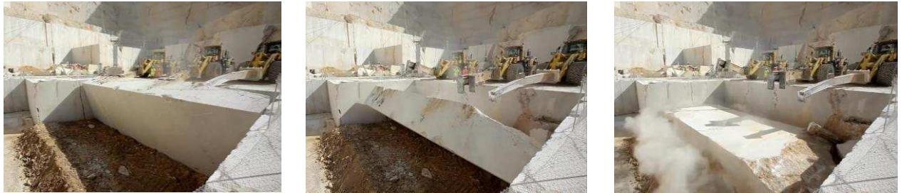
Рис. 6.16. Опрокидывание монолита колёсными машинами
