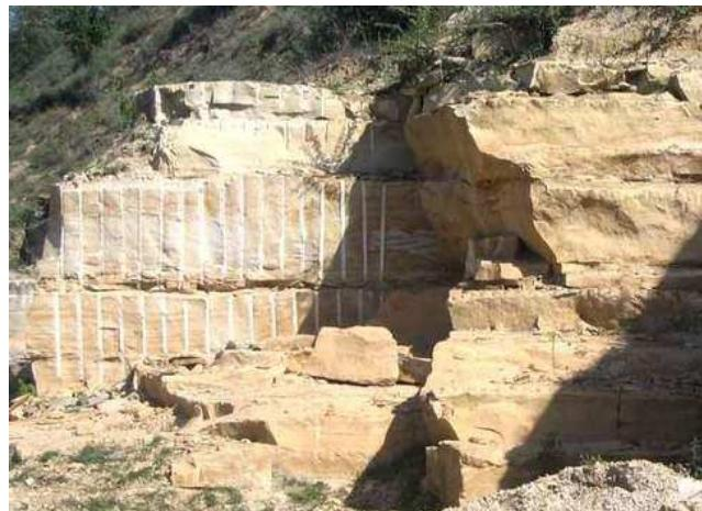
Рис. 6.14. Следы шпуротов на откосе массива после откола блока смесью НРС
