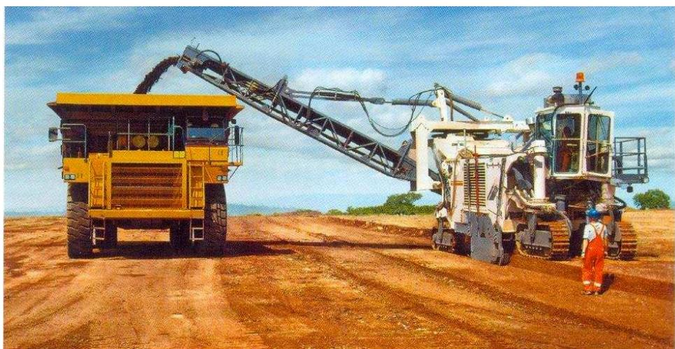
Рис. 5.37. Работа комбайна Wirtgen 2500 SM на бокситах Гвинеи
