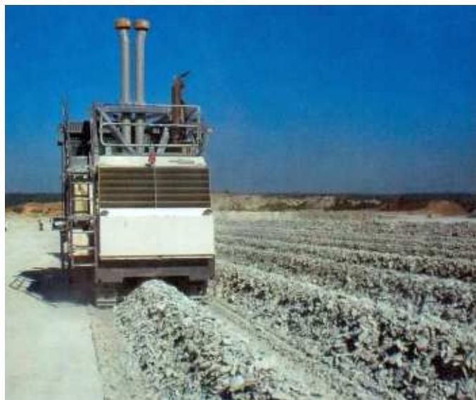
Рис. 5.34. Комбайн Wirtgen 2200 SM с технологией «windrows» на карьере известняков
