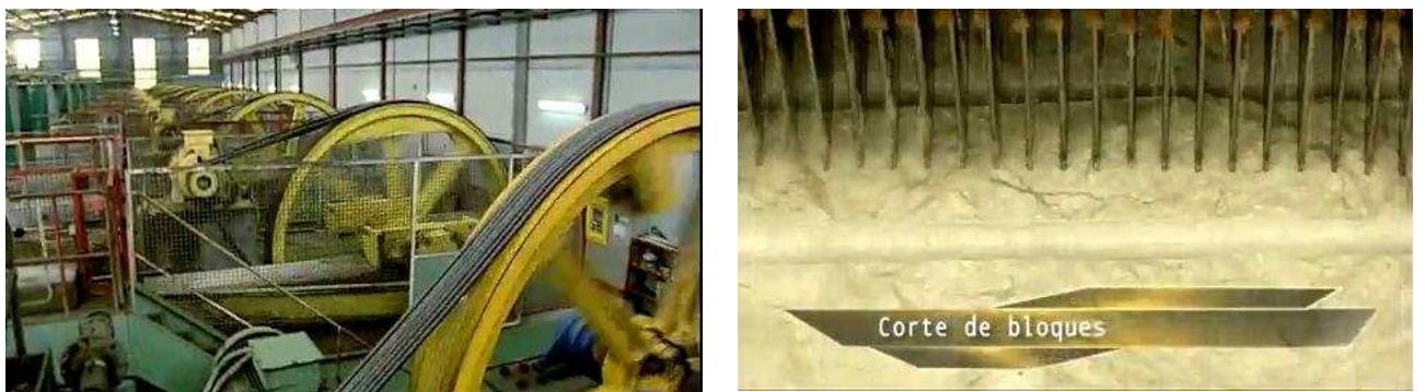
Рис. 6.24. Разделка монолита на заводе пильными станками
