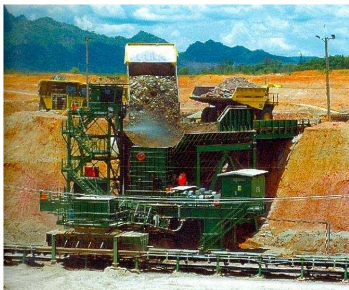
Рис. 5.44. Передвижная дробильная станция производительностью 5 500 т/ч
