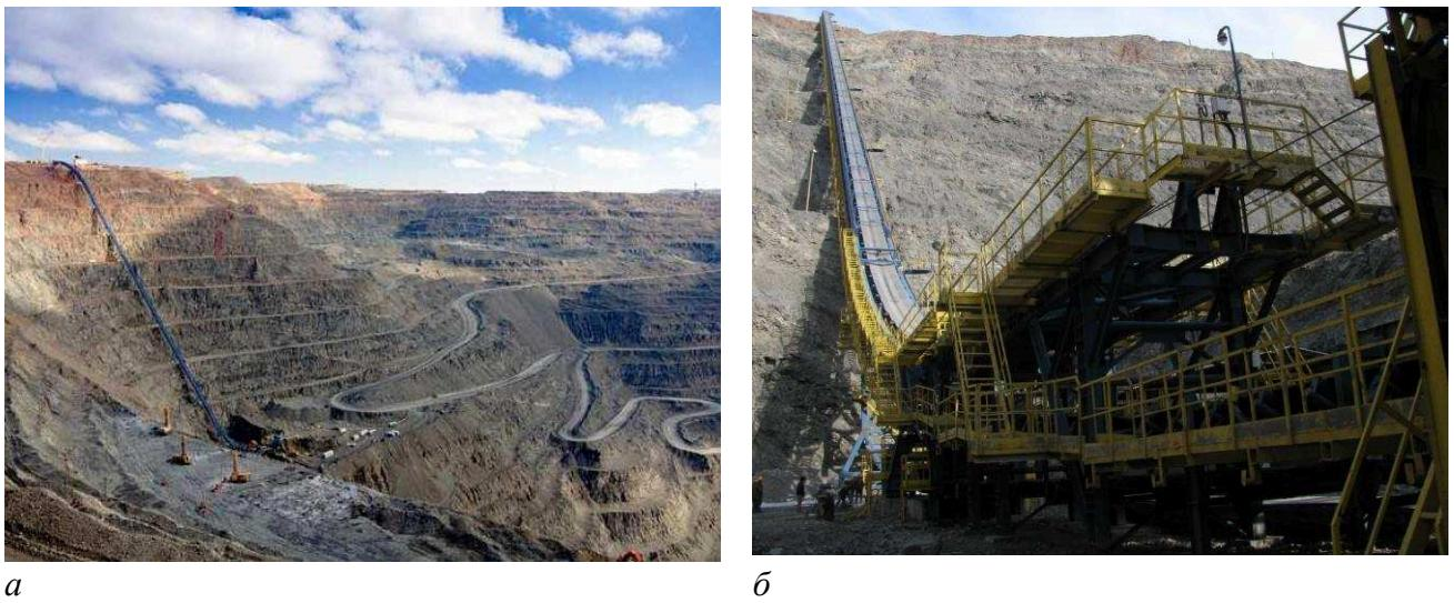
Рис. 5.46. Наклонная часть КНК-270/3500 на карьере «Мурунтау»
