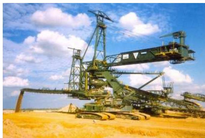
Рис. 5.59. Консольный отвалообразователь в работе
