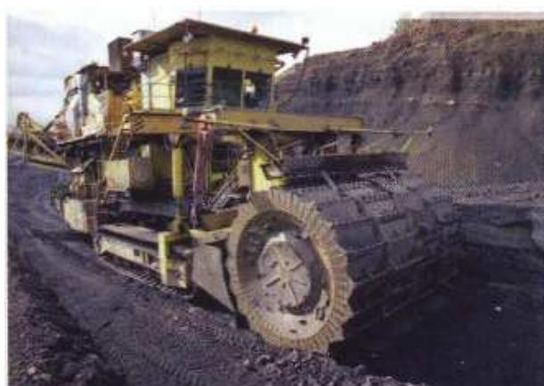
Рис. 5.28. Карьерный комбайн фирмы Krupp типа КСМ
