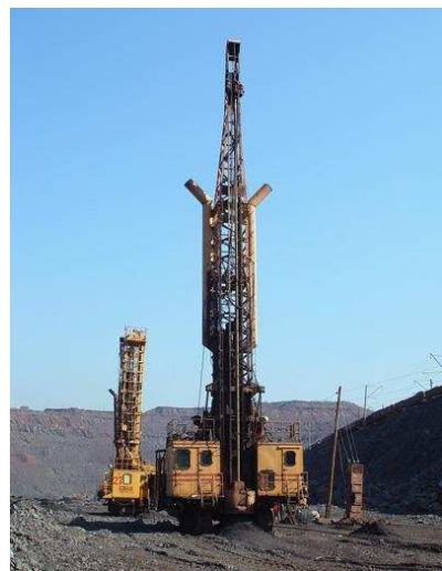
Рис. 4.4. Станок термошарошечного бурения типа СБТ
