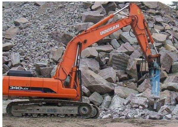
Рис. 4.15. Бутобой на базе гидравлического экскаватора
