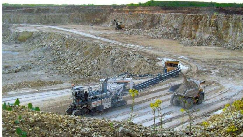
Рис. 5.36. Работа комбайна Wirtgen 2500 SM на Сокольско-Ситовском карьере
