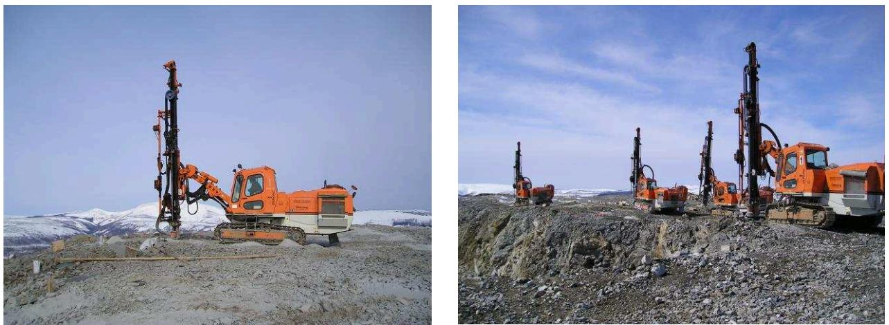
Рис. 4.1. Станки вращательно-ударного бурения в забое
