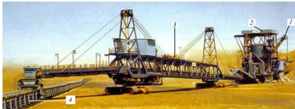
Рис. 5.43. Мобильный комплекс внутрикарьерного дробления:
