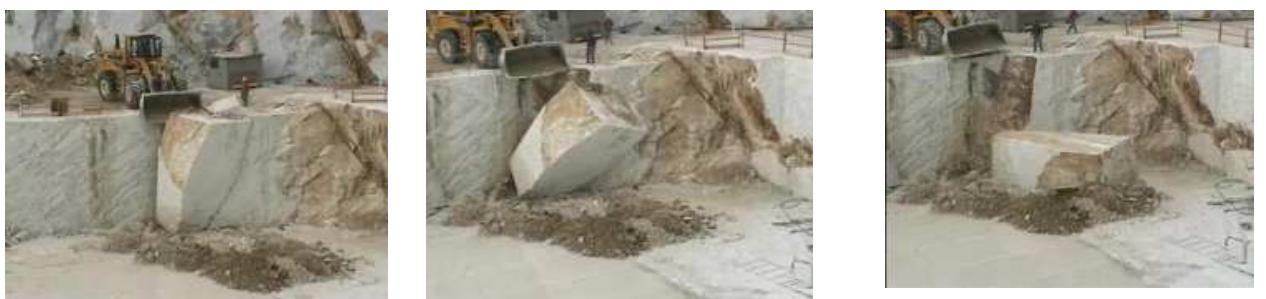
Рис. 6.18. Опрокидывание блока фронтальным погрузчиком
