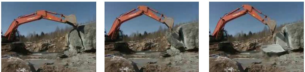
Рис. 6.17. Отделение каменного блока от массива горных пород обратной лопатой
