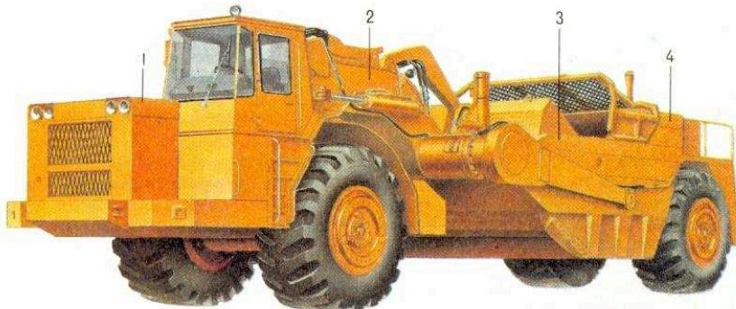
Рис. 5.25. Двухмоторный скрепер ДЗ-107-1 с ковшом ёмкостью 25 м<sup>3</sup>:
