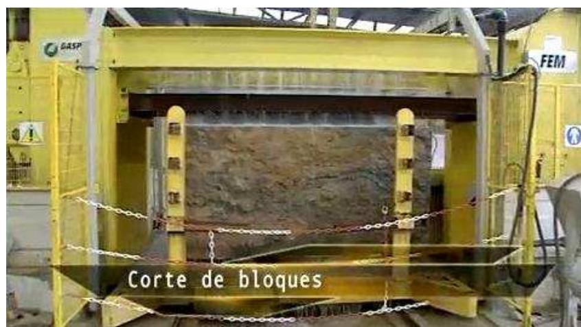
Рис. 6.22. Установка для разделки монолитов на плиты в карьере
