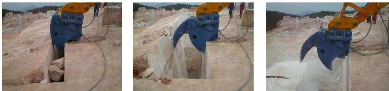
Рис. 6.15. Отделение монолита от массива горных пород раздвижным устройством
