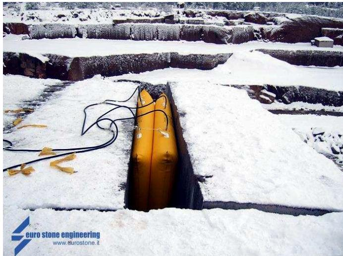
Рис. 6.19. Отделение блока пневматической конструкцией
