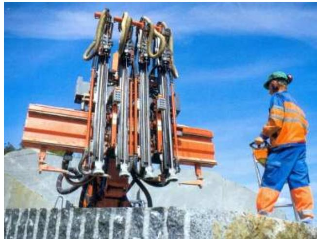
Рис. 6.12. Станок строчечного бурения
