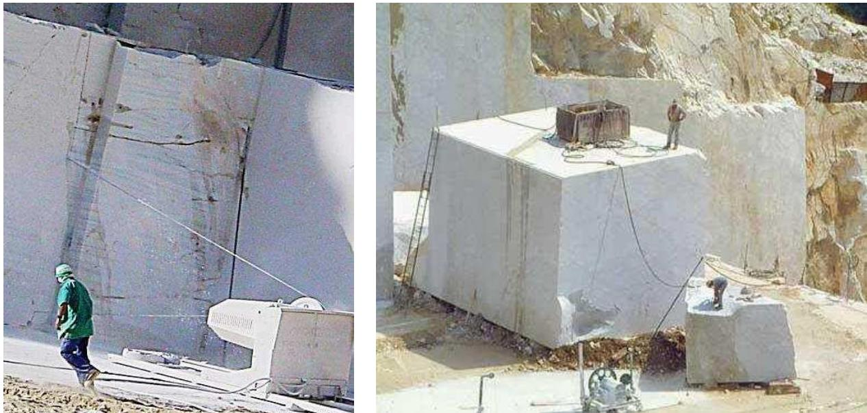
Рис. 6.11. Канатная пила на выполнении вертикального реза (а) и блок камня (б)
