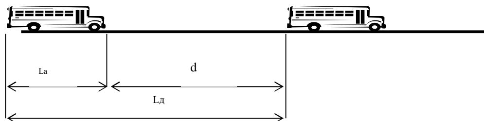
$L_d$  – динамический габарит автомобиля,  $L_a$  – длина автомобиля,  $d$  – дистанция безопасности
