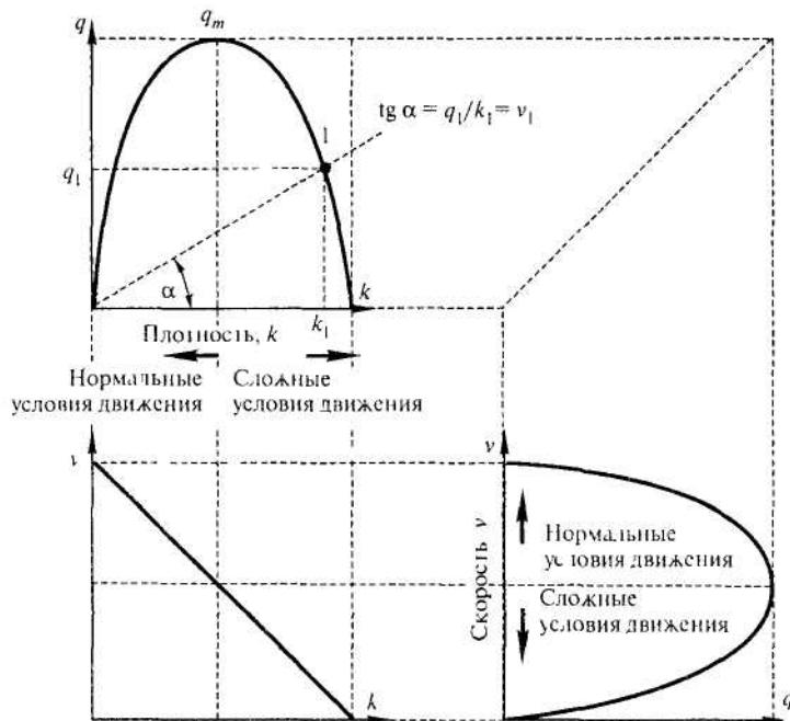
Рис . Зависимость между интенсивностью, плотностью и скоростью транспортного потока и пропускной способности при планировании мероприятий по совершенствованию организации дорожного движения и развитию улично-дорожной сети.
