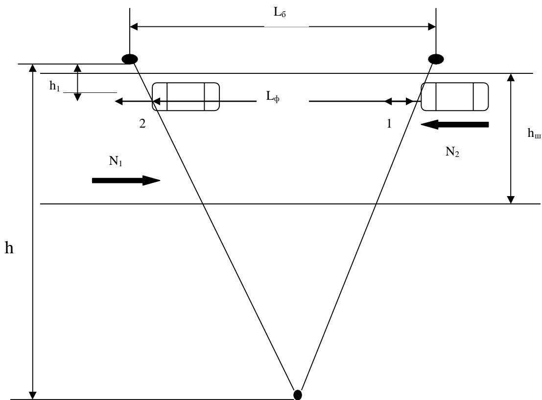
Рис. 7 Схема оформления протокола измерения мгновенных скоростей
