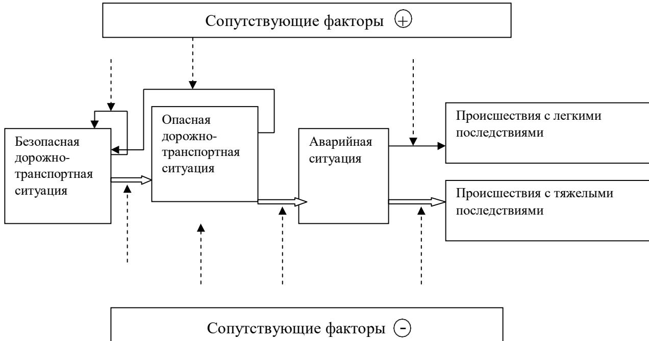
Рис . Схема зарождения и развития дорожно-транспортного происшествия
