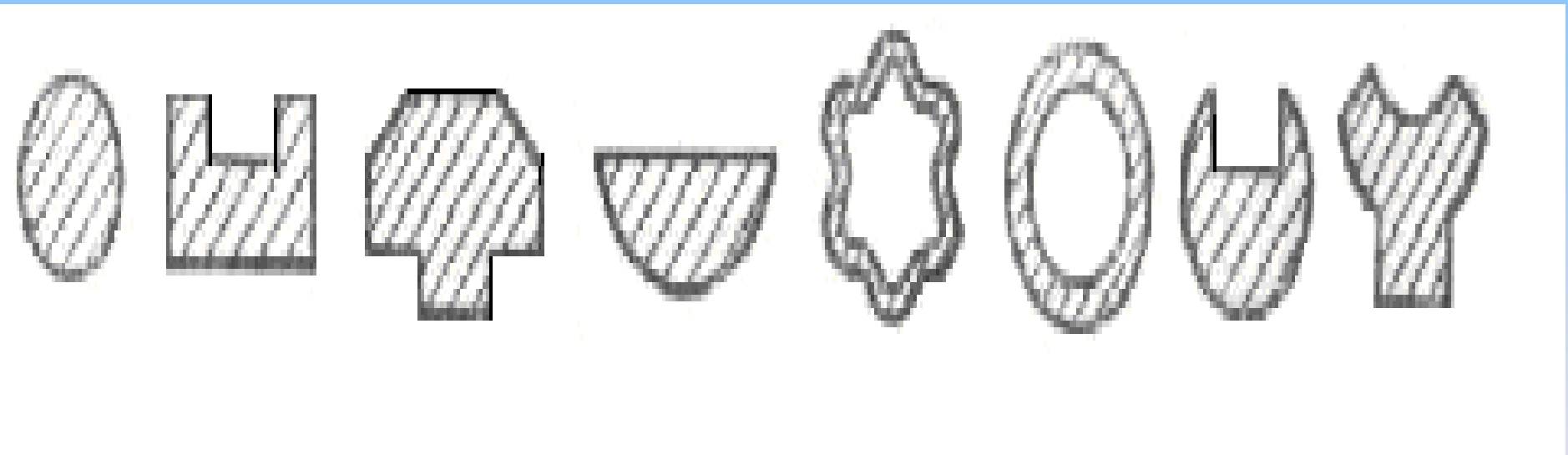
Рис.10. Профили, получаемые волочением
