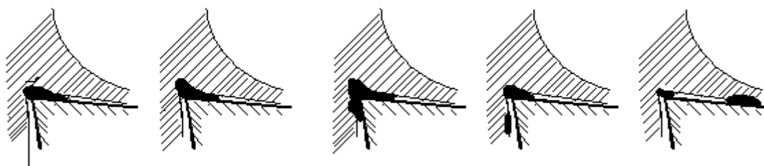
Рисунок 4. Образование и срыв нароста.
