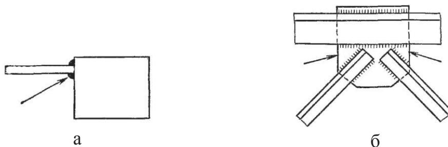
*Рис. 19.1. Примеры нерациональных конструкций, вызывающих концентрацию напряжений и разрушение при низкой температуре:
