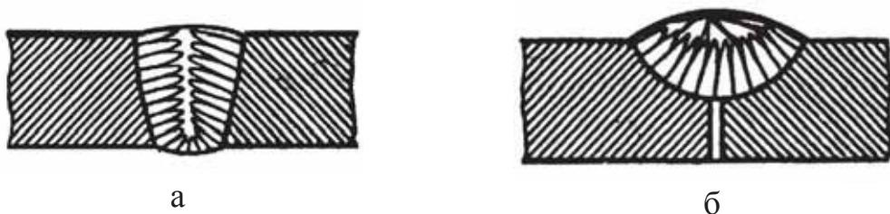
*Рис. 5.3. Схема кристаллизации расплава в зависимости от формы сварочной ванны: а – узкая сварочная ванна с глубоким проплавлением; б – широкая сварочная ванна*
