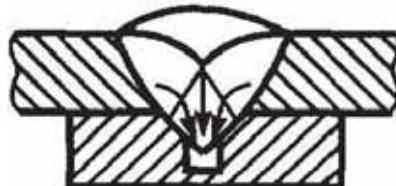
*Рис. 17.1. Подкладка для сварки алюминиевых сплавов*
