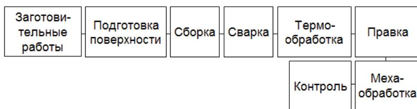
Рис. 20.1. Схема технологического процесса
