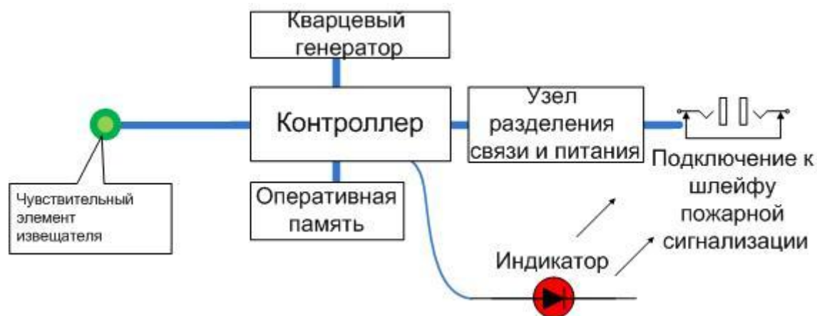
Рис. 1 Упрощенная структурная схема современного адресно-аналогового извещателя.
