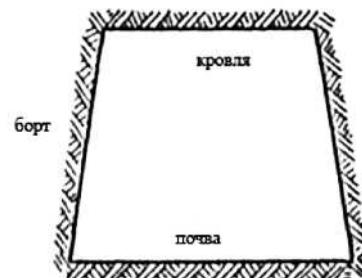
Рис. 3.8. Поперечное сечение горной выработки
