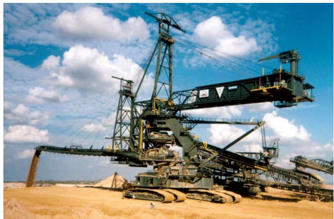
Рис. 5.28. Конвейерный отвалаообразователь
