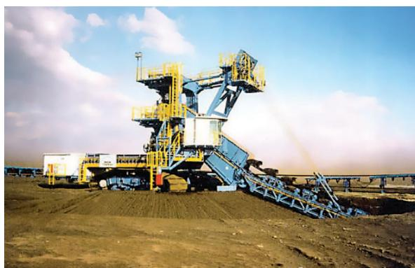
Рис. 5.15. Цепной экскаватор на рельсовом ходу
