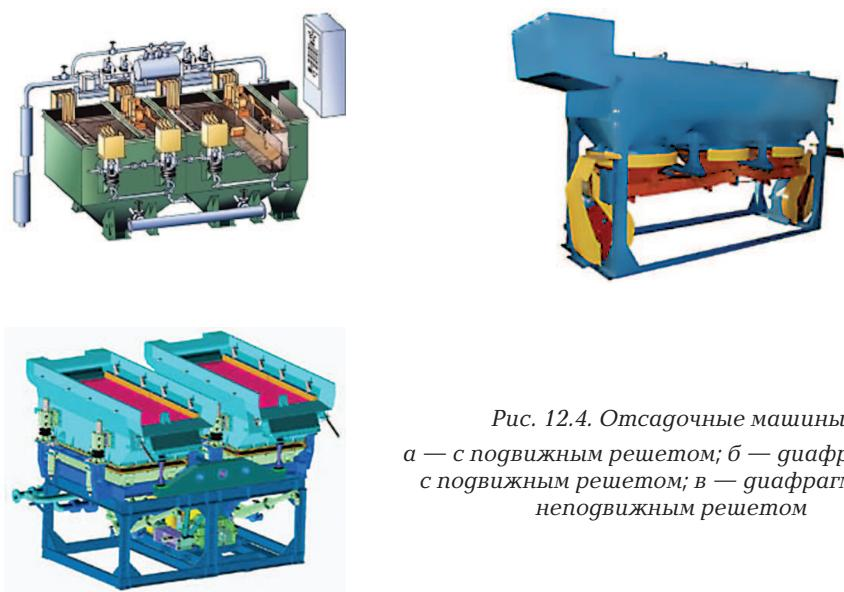
Рис. 12.4. Отсадочные машины:
