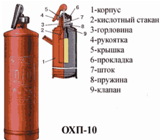
Рисунок 2 – Химический пенный огнетушитель ОХП-10
